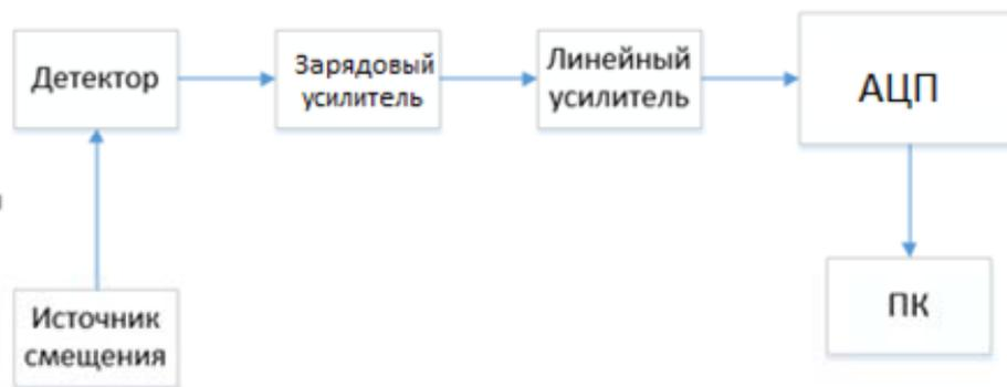
Рисунок 1- Блок схема спектрометра
