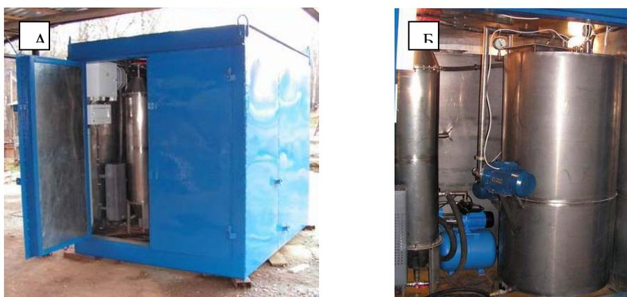
Рисунок 1. Общий вид (А) и компоновка узлов (Б) малогабаритной блочно-модульной станции очистки воды по патенту № 142624.
