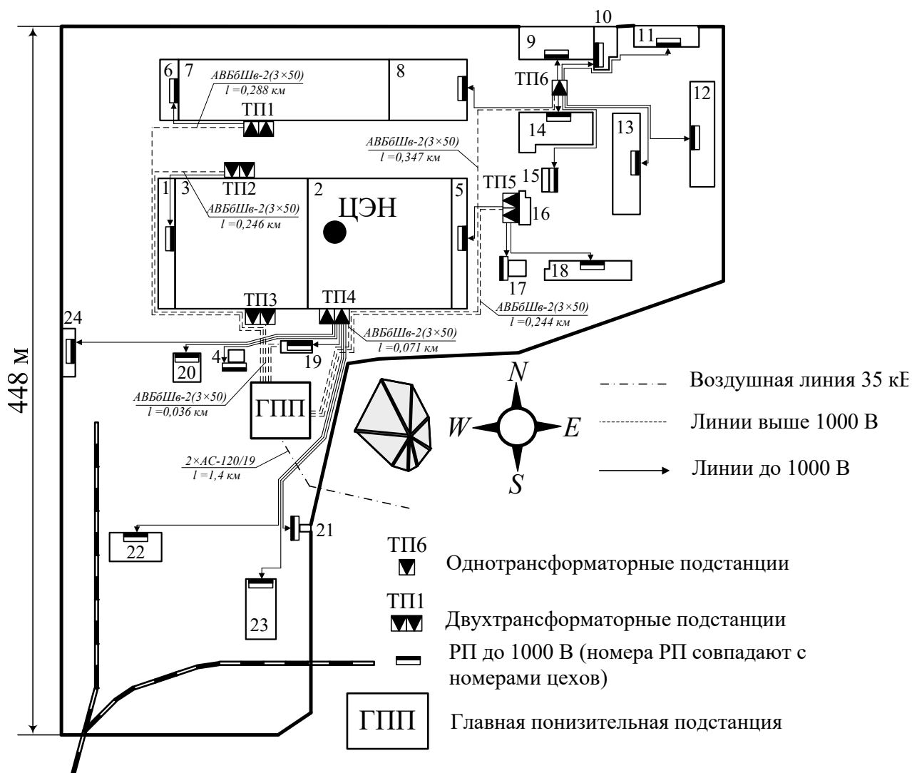
Рисунок 3.8 – Схема распределения электроэнергии по территории предприятия
