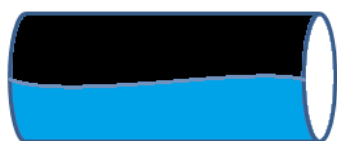
а) Волновая структура потока «нефть- вода»
