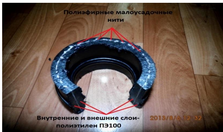
Рисунок 4.11. Структура полиэтиленовой трубы
