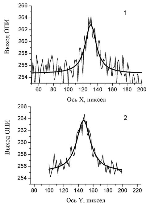
Рис. 9. Сечение интенсивности ОПИ для пучка 2×2 мм: 1) горизонтальное; 2) вертикальное
