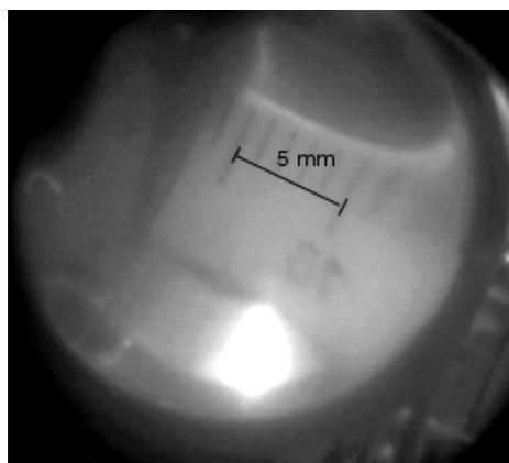
Рис. 7. Фотография линейки для калибровки оптической системы
