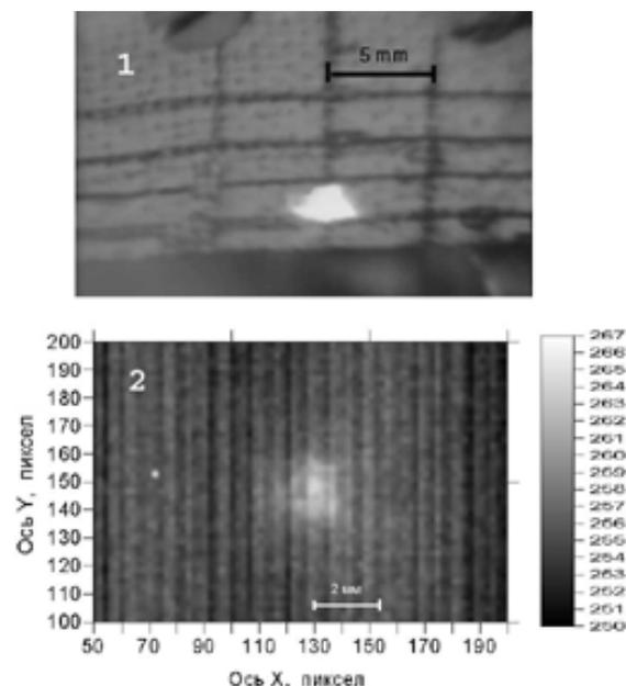
Рис. 8. Фотография электронного пучка размерами 2×2 мм: 1) излучение на люминофоре; 2) ОПИ на алюминиевой пластине
