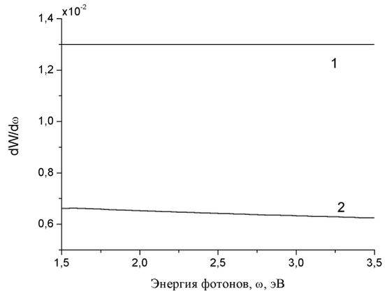
Рис. 3. Спектр оптического переходного излучения: кривая 1) для идеальной мишени; 2) для алюминиевой мишени
