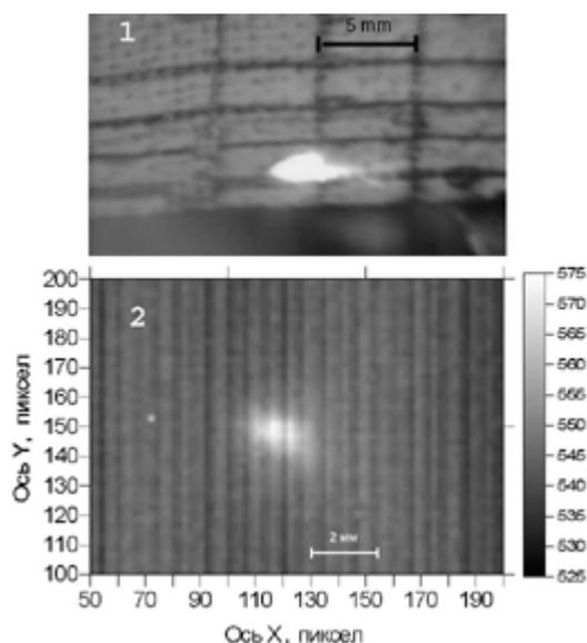
**Рис. 10.** Фотография электронного пучка размерами 1х3 мм: 1) излучение на люминофоре; 2) ОПИ на алюминиевой пластине
