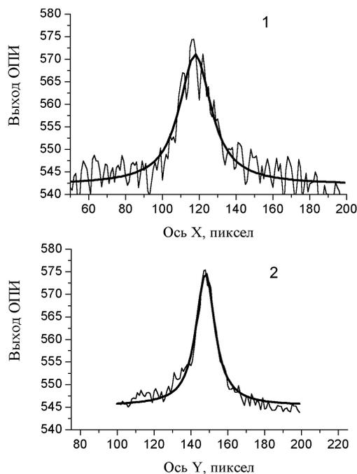
**Рис. 11.** Сечение интенсивности ОПИ для пучка 1х3 мм: 1) горизонтальное; 2) вертикальное
