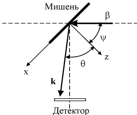
Рис. 1. Система координат для расчета переходного излучения
