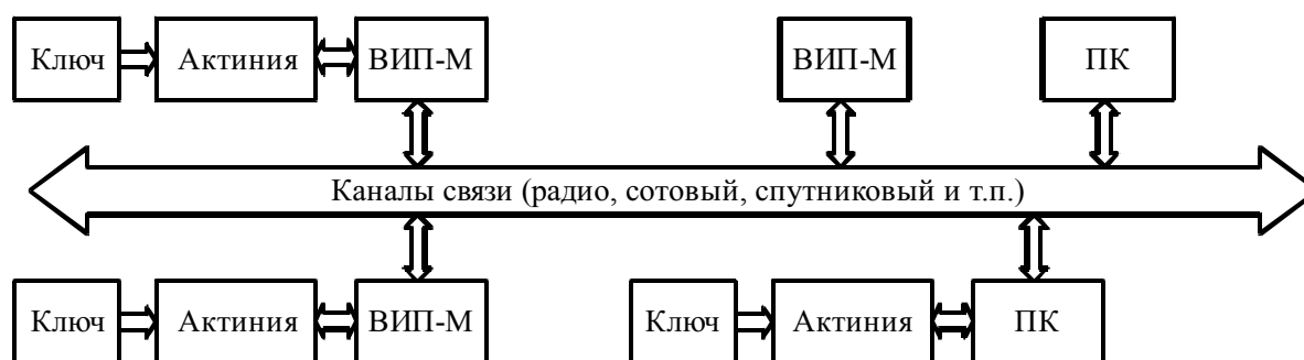
Рис. 1. Система передачи данных, включающая СКЗИ. ПК – персональный компьютер
