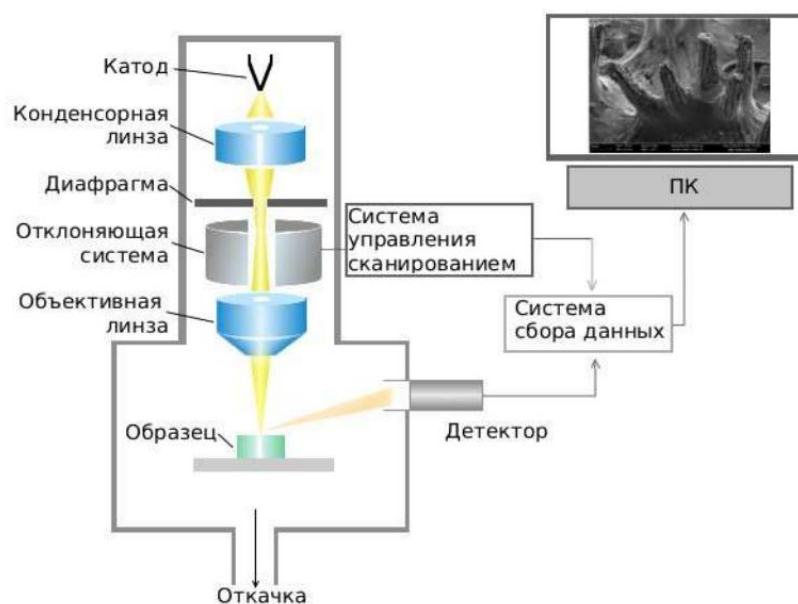
Рисунок 9 – Принципиальная схема сканирующего электронного микроскопа
