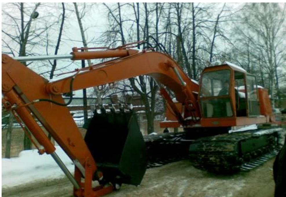
**Рис. 8.** Экскаватор с сильно развитой опорной поверхностью с резинометаллической гусеницей МТП-71 (ЭО-4221)
