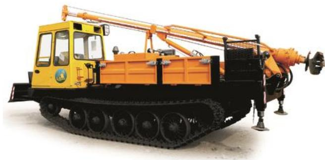
**Рис. 19.** Бурильно-крановая машина БКМ-534
