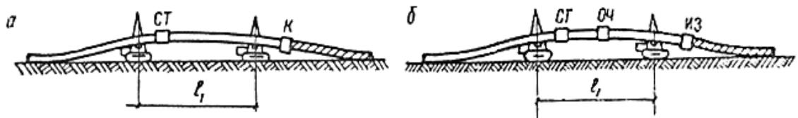
**Рис. 10.** Схема расположения трубоукладчиков и машин в изоляционно-укладочной колонне при раздельном способе производства работ для трубопровода диаметром до 820мм:
