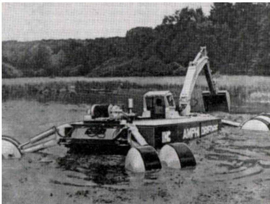
**Рис. 7.** Экскаватор с корпусом-понтонем «Конни Слайдрехт»
