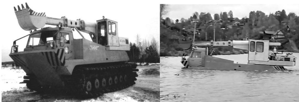
**Рис. 9.** Современный плавающий экскаватор ТТМ-6901Э
