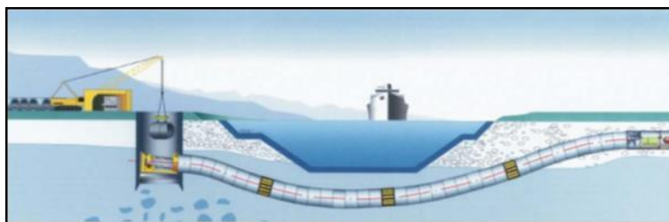
Рис. 1.7 – Метод тоннелирования с использованием проходческого щита [6]
