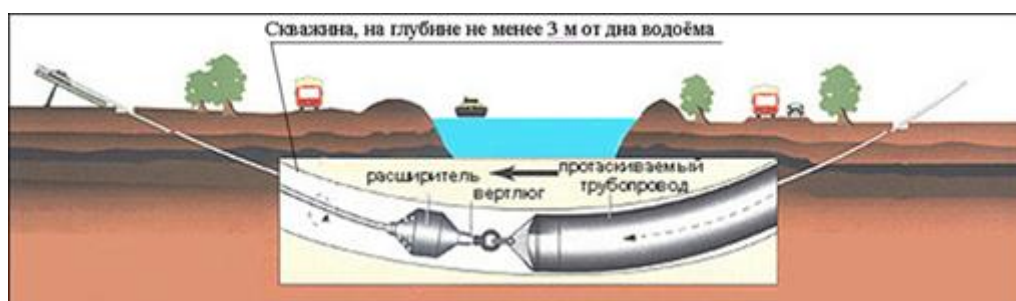
Рис. 1. 6 – Метод прокладки способом наклонно – направленного бурения [6]
