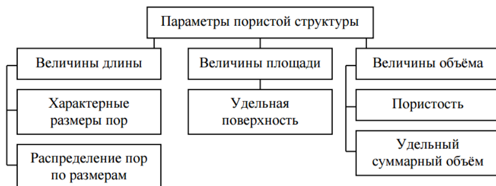
Рисунок – 1.6 Классификация параметров пористой структуры
