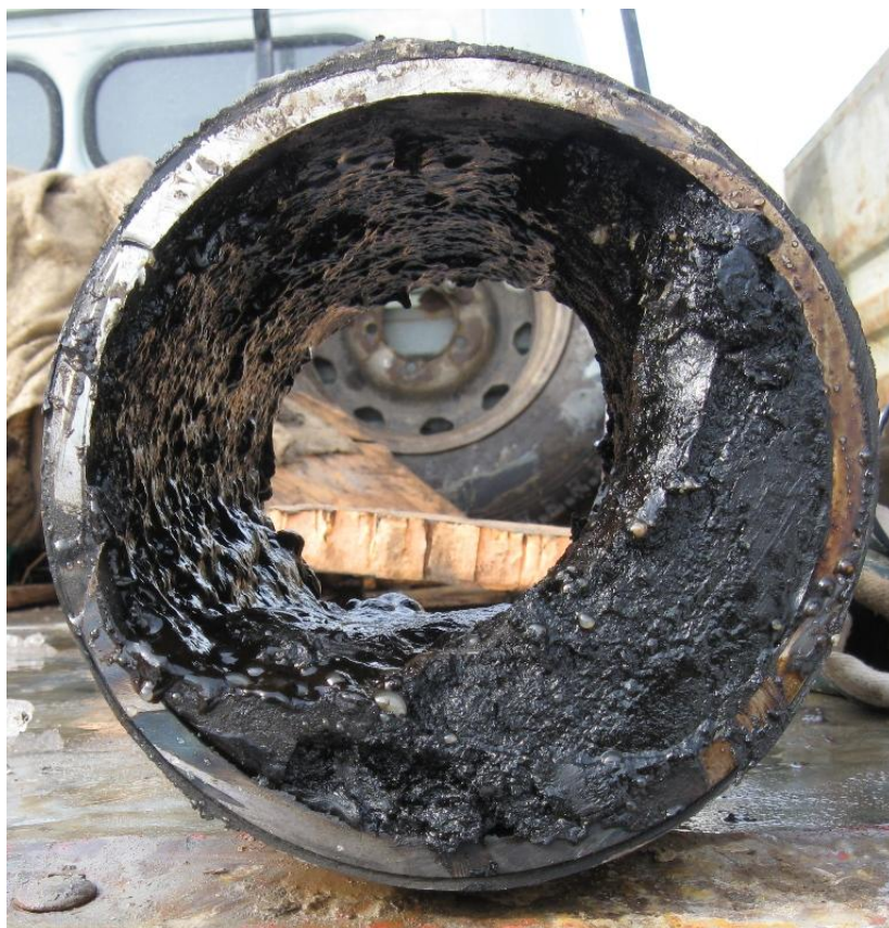
Рисунок 4.9 – Отложение АСПО в трубе диаметром 159 мм.
