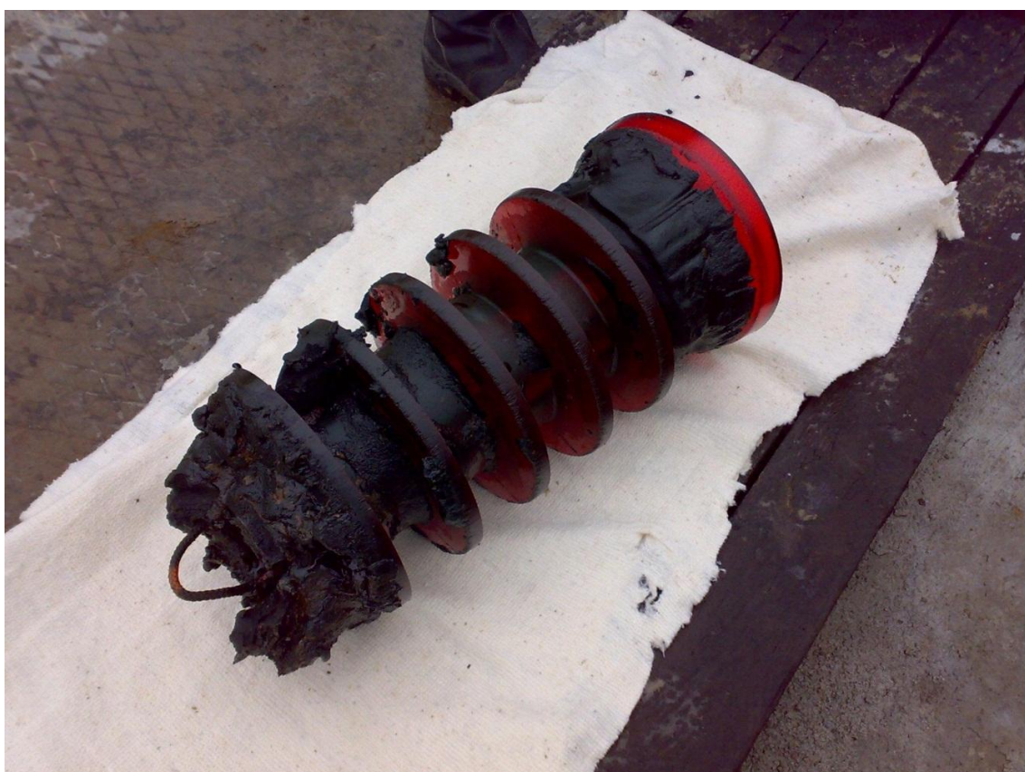
Рисунок 4.17 - Очистное устройство поршень Семигор-5Д1М-219 извлеченное из камеры приема
