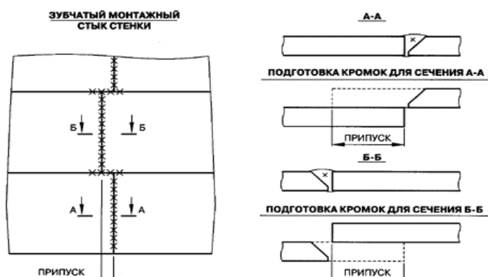
Рис. 17 - Зубчатый монтажный стык стенки резервуара
