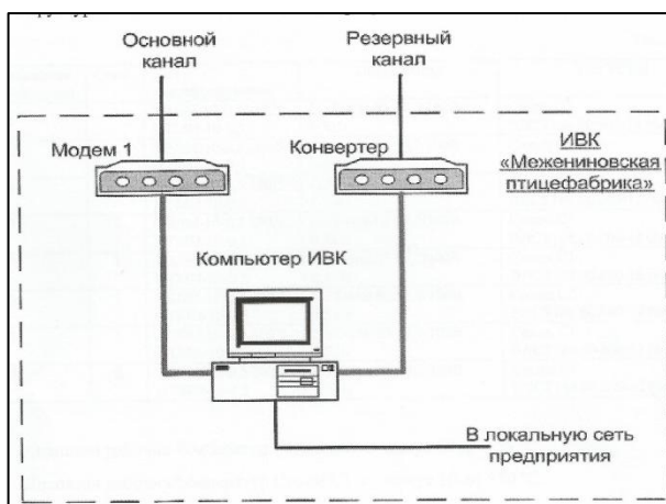
Рис. 3. Обобщенная структурная схема ИВК
