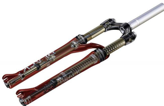
Рисунок 3.2 – Пружинно–эластомерный велосипедный амортизатор
