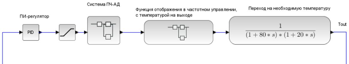
Рисунок 1.6.1 – Контур для определения устойчивости
