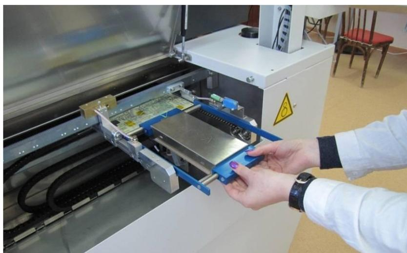
Рисунок 4.4 – Установка платы и датчика в печь для снятия температурного профиля
