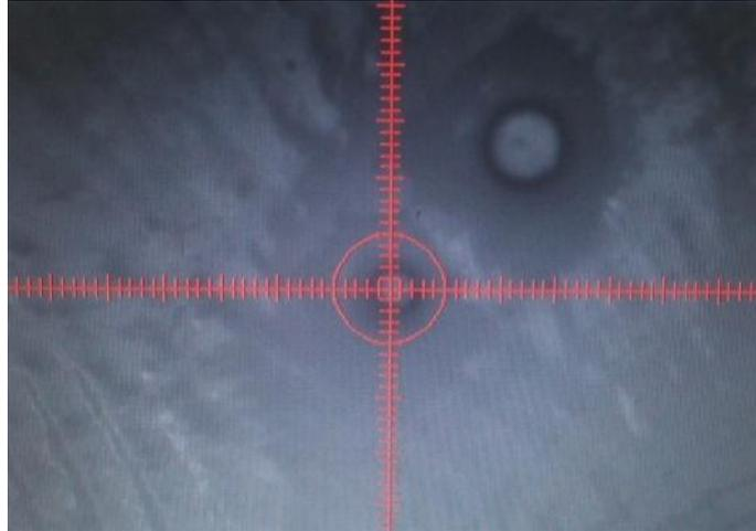
Рисунок 17 – Вид с камеры отпечатка на герметике
