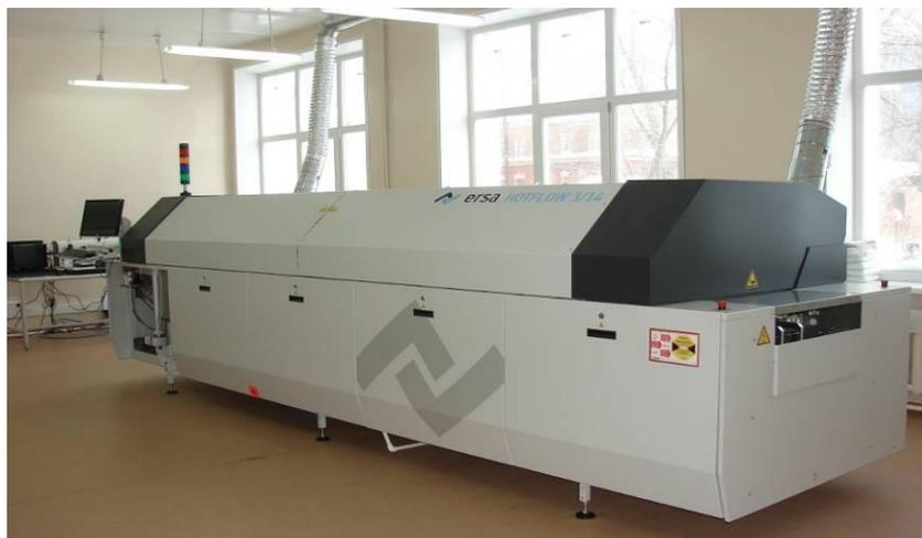
Рисунок 3.11 – Система конвекционного нагрева ErsasHotflow 3/14
