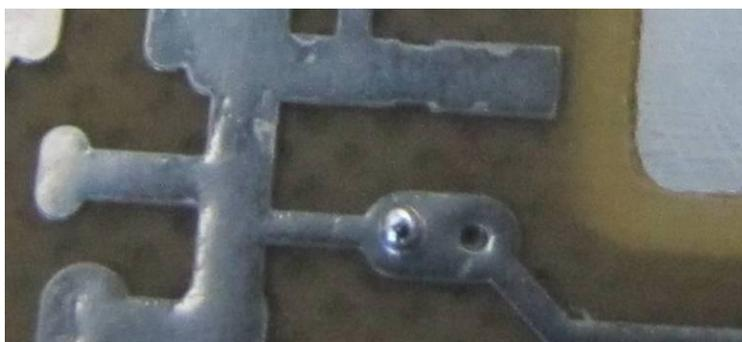
Рисунок 4.13 – Шарик припоя в переходном отверстии
