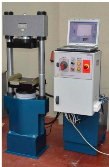
Рисунок 13 – Гидравлический испытательный пресс ИП-500
