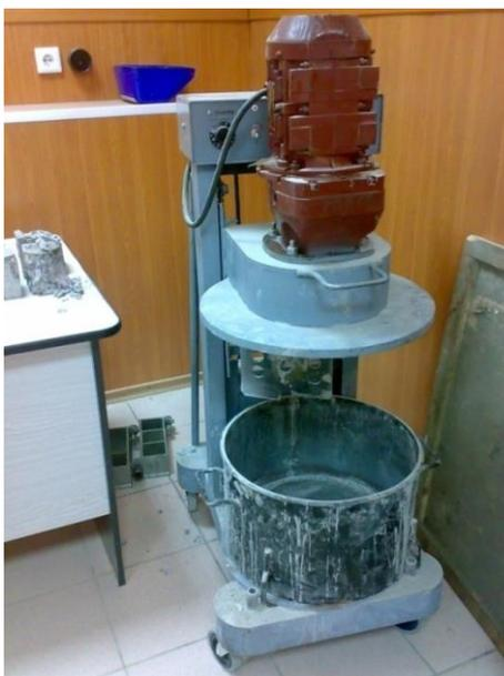
Рисунок 16- Лабораторная мешалка МЛЖ-30
