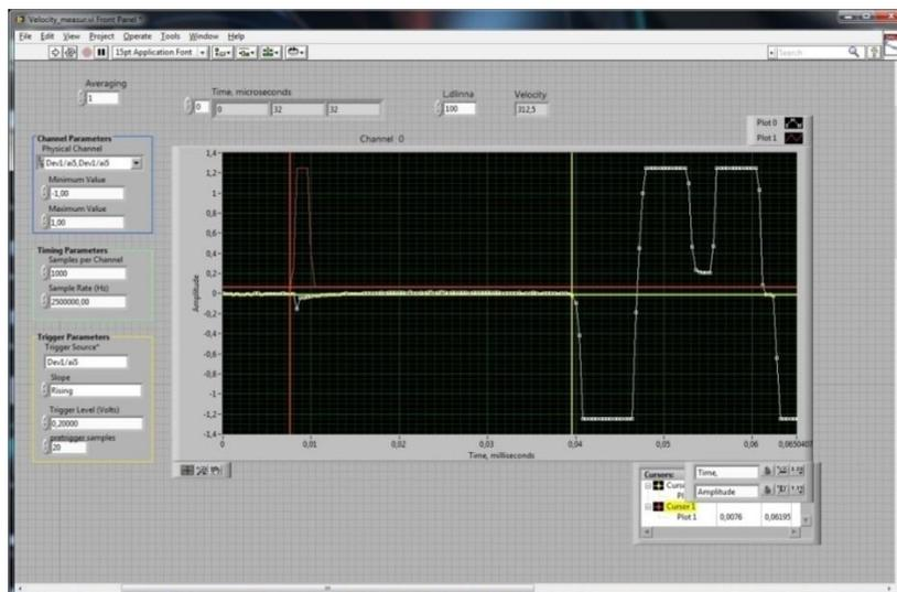
Рисунок 12 – Рабочее окно программы для измерения скорости продольных акустических колебаний
