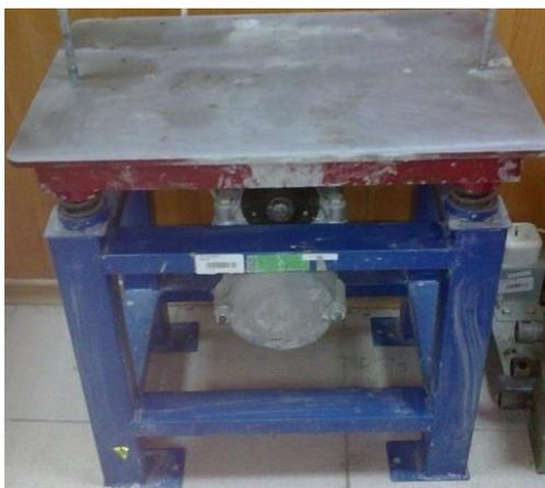
Рисунок 18 – Лабораторная виброплощадка СМЖ-539
