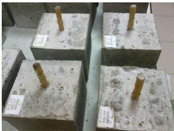
Рисунок 19 – Готовые образцы бетона, армированного стеклопластиковой арматурой
