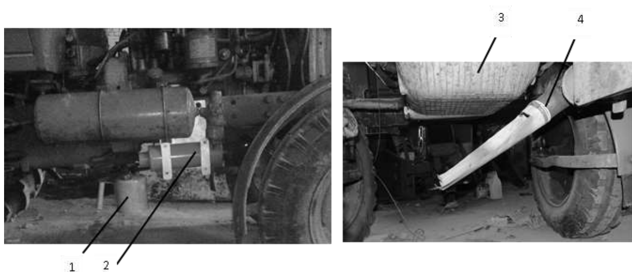
Рисунок 3.7 Предпусковой подогреватель двигателя Д-240 на базе бензиновой горелки:
