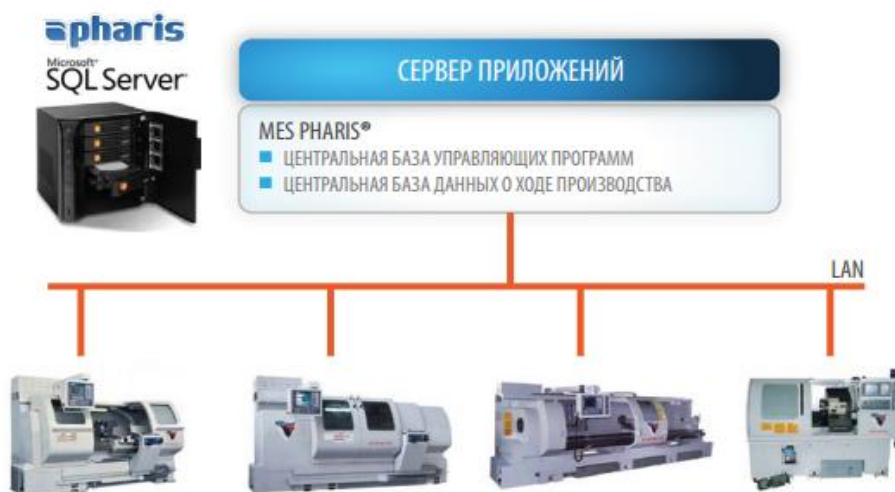
Рисунок 9 – станки ЧПУ фирмы «MES PHARIS®»
