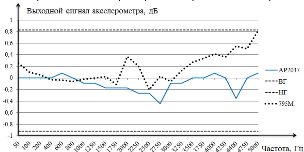
Рис. 2 Амплитудно-частотная характеристика способа крепления при помощи шпильки, полученная экспериментально.
