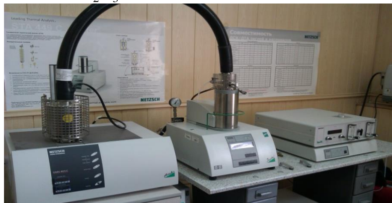
Рисунок 7 – Комплексное оборудование - термоанализатор STA 449 C Jupiter и масс-спектрометр QMS 403C Aëlos
