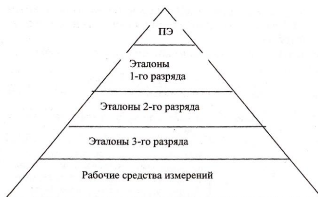
Рисунок 1 - Схема передачи размера от Первичного эталона (ПЭ) рабочим средствам измерений
