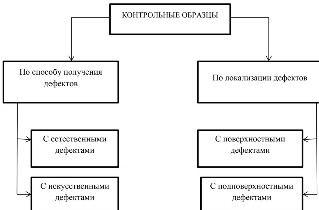
Рисунок 1. Классификация контрольных образцов
