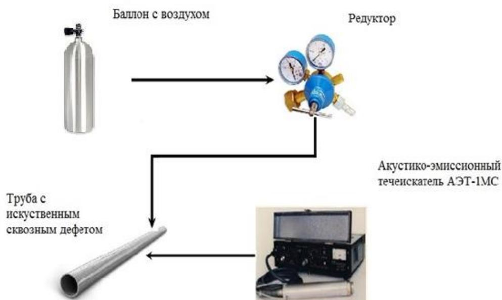
Рис.1. Структурная схема лабораторного стенда
