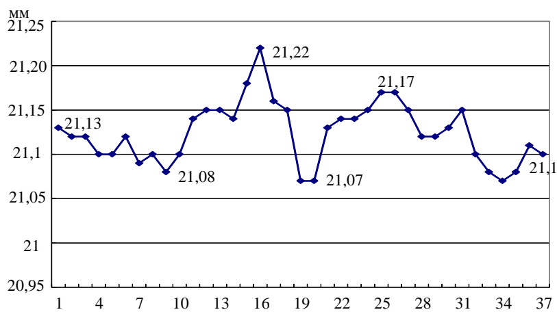
Рис.5. Экспериментальным путем измерения внутреннего диаметра трубы 21 мм.
