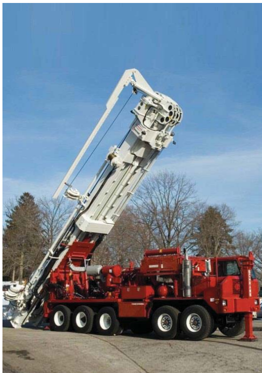
Рис. 1. Мобильная буровая установки T130XD
