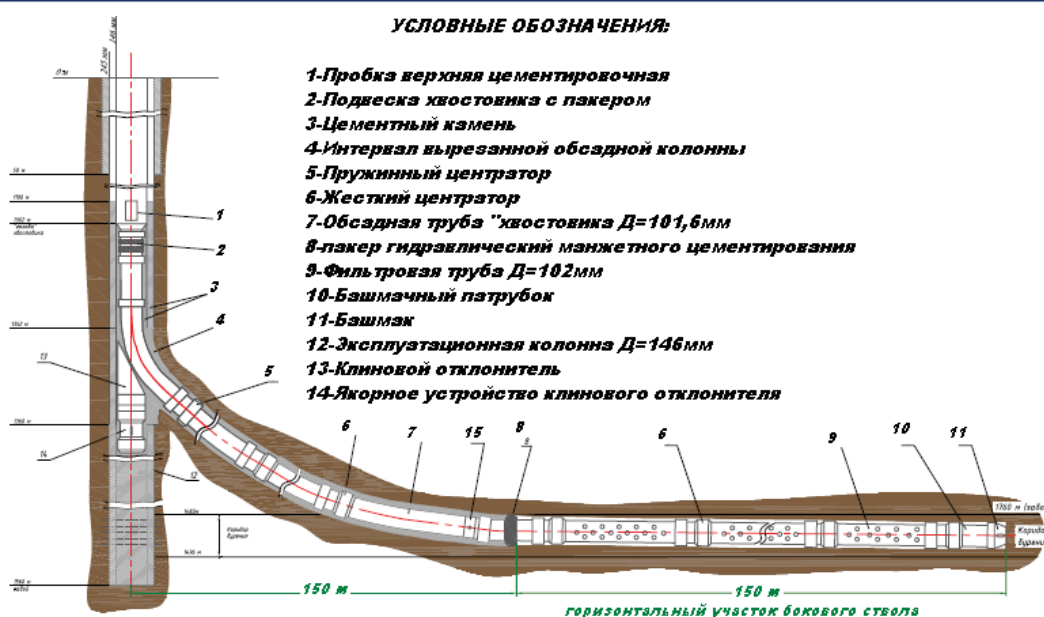
Рис.2. Типовая конструкция скважины после зарезки бокового ствола
