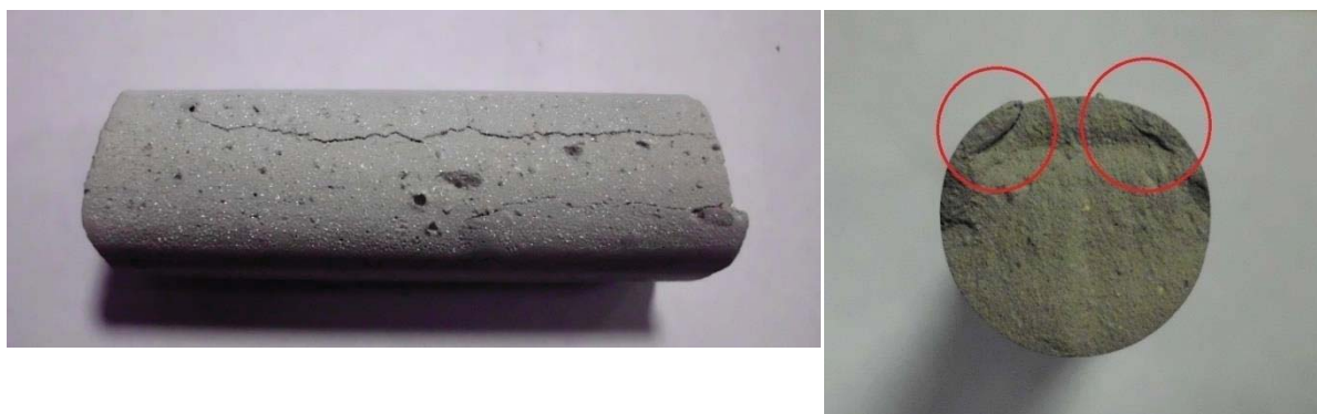
Рис. 4 – Трещины в цементном камне у верхней стенки
