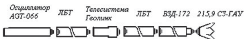
Рис. 1 Компоновка низа бурильной колонны, применявшейся в РТ при бурении битумной скважины
