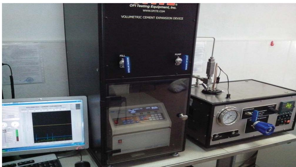
*Рис. 1- Ультразвуковой анализатор цемента (внешний вид)*
