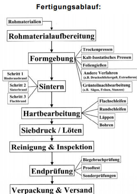
Abb.1. Herstellung von Aluminiumnitrid-Keramiken[2]
