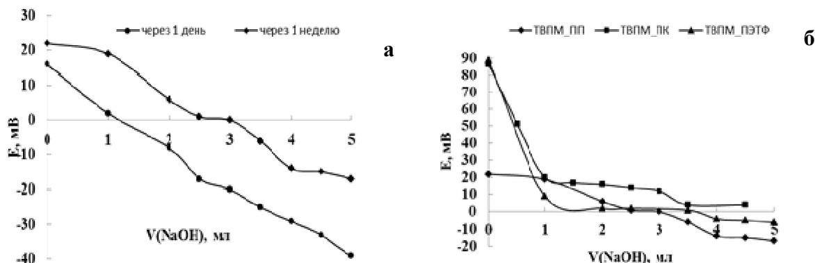
Рис. 1. Кривые потенциометрического титрования ТВПМ в водно-ДМФ среде раствором NaOH: а – ТВПМ на основе ПП во времени; б – ТВПМ на основе ПП, ПЭТФ и ПК (измерение  $E$  через неделю)
