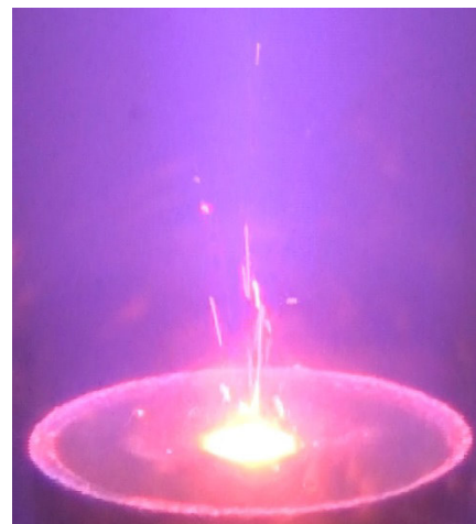
Рис. 2. Разлет частиц порошка при мгновенном облучении электронным пучком (плотность мощности электронного луча P_S = 120 \text{ Вт/см}^2 )
