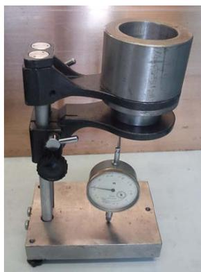
Рис. 1. Приспособление для подачи порошка
