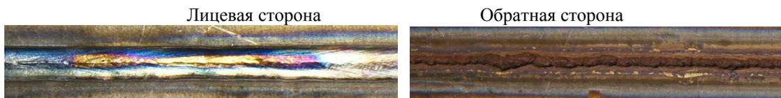
Рис. 3. Внешний вид сварного соединения,  $\Delta f = 1$  мм
