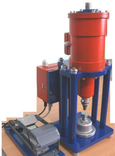
Рис. 1. Электромагнитный пресс.
