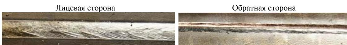
Рис. 4. Внешний вид сварного соединения, полученного с подачей присадочной проволоки
