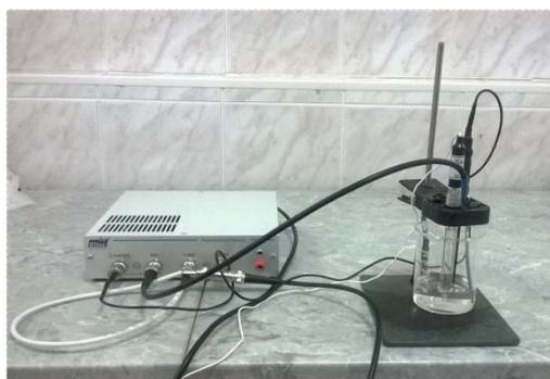
Рис. 2. Установка РМС-Х «Электрохимия»
