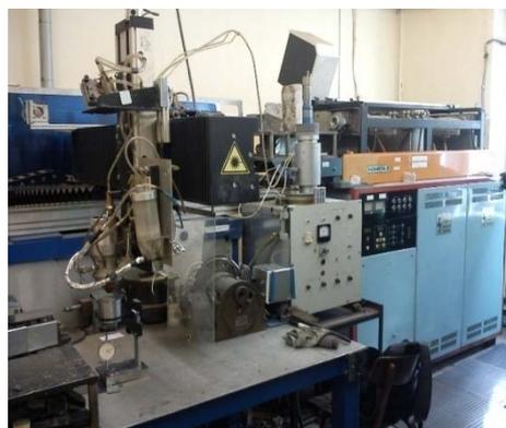
Рис. 2. Установка для селективного лазерного спекания
