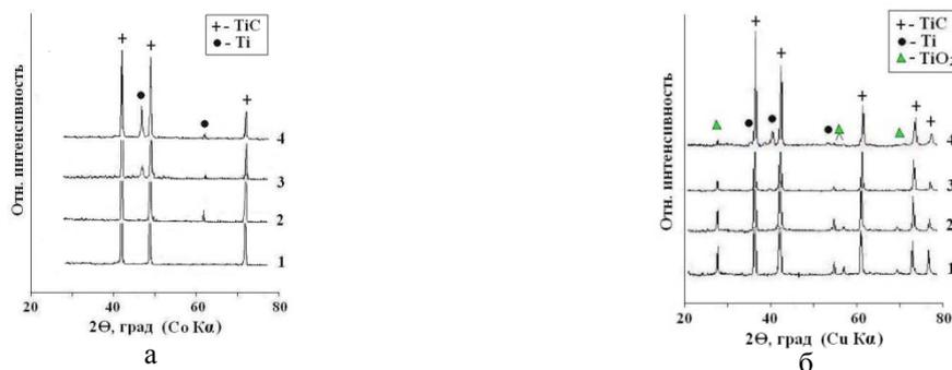
Рис. 1. Рентгенограммы СВС-порошков  $TiC_x + Ti$ , синтезированных в аргоне (а) и на воздухе (б). Расчетное (при  $X=1$ ) содержание титановой связки: 1 - 30об.%, 2 - 40об.%, 3 - 50об.%, 4 - 60об.%
