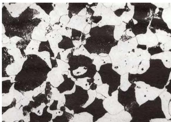
Рис. 3. Микроструктура исходного состояния стали 40Л
