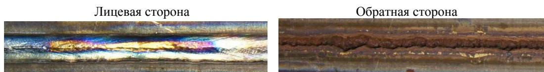
Рис. 2. Внешний вид сварного соединения, выполненного ЛАДС,  $V_{св} = 0,72$  м/мин
