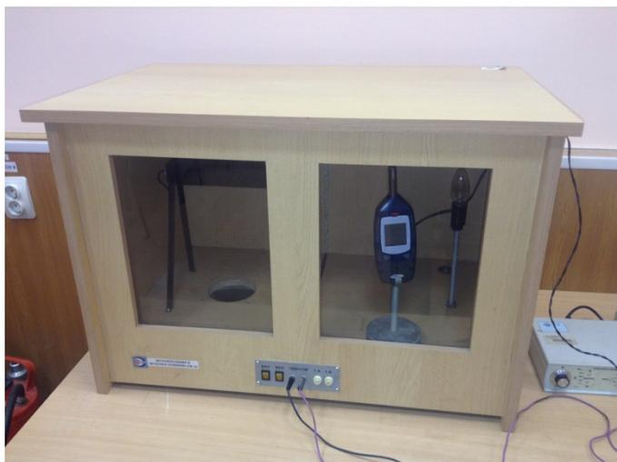
Рис. 6. Общий вид стенда «Звукоизоляция и звукопоглощение – БЖ 2м»
