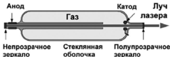
Рис. 2. Устройство СО<sub>2</sub> лазера
