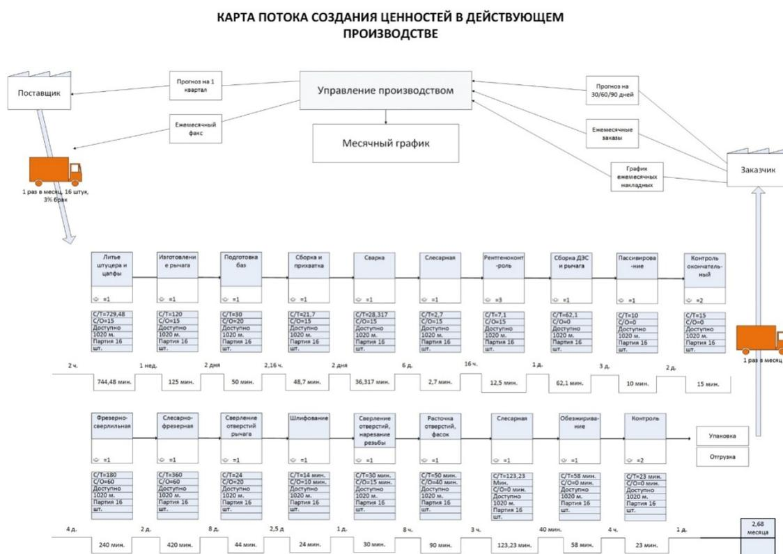
Рис. 1. Карта потока создания ценностей в действующем производстве
