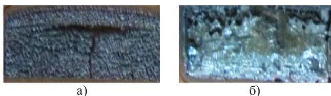
Рис. 5. Внешний вид спеченной поверхности ПМС-1 (x2), режимы спекания:  $P=30$  Вт,  $V=200$  мм/мин,  $S=0,1$  мм,  $t=200$  °С, а – на воздухе; б – в аргоне
