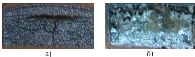
Рис. 5. Внешний вид спеченной поверхности ПМС-1 (x2), режимы спекания: P=30 Вт, V=200 мм/мин, S=0,1 мм, t=200 °С, а – на воздухе; б – в аргоне
