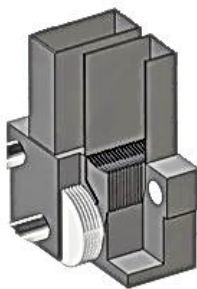
Рис. 7. Многосопловое устройство подачи порошка с дозирующим подающим валиком в виде набора тонких дисков(порядка 1мм), снабженных каждый индивидуально управляемым приводом, образующего многосопловую линейную систему
