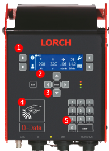
Рис. 1. Рекордер системы документирования Q-Data: 1 - ЖК-дисплей с контекстно-чувствительными клавишами прямого управления; 2 - Воспроизведение сохранённых параметров в режиме реального времени: сварочный ток, сварочное напряжение, подача проволоки, объём потока газа; 3 – клавиши управления меню; 4 – система распознавания RFID для идентификации сварщика; 5 - числовой блок для ввода номеров заказов, деталей, сварных швов и WPS
