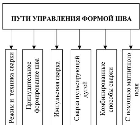
Рис. 1. Способы управления формой сварного шва
