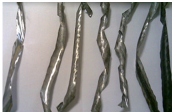
Рис. 2. Появление следов конденсата на поверхности лент брони в ходе теплового старения при 100 °С
