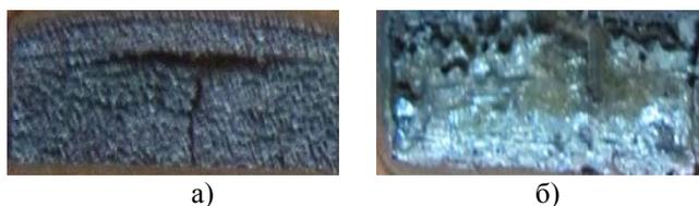
Рис. 1. Внешний вид спеченной поверхности ПМС-1 ( $\times 2$ ).
