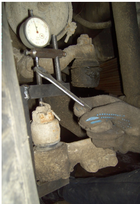
Рис. 1. Установка скобы на рулевой шарнир
