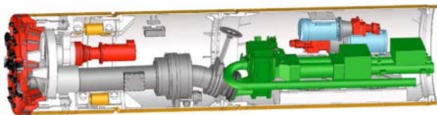
Рис. 2 Погрузка породы в щите для микротоннелирования
