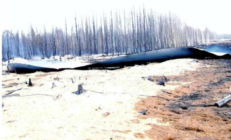
Рисунок 1.3. Фрагменты газопровода после его разрушения по причине КРН
