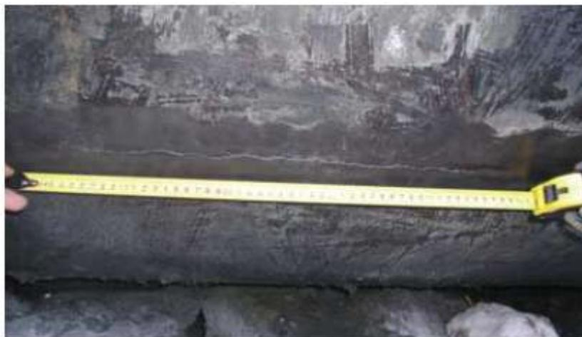
Рис. .3.3. Стресс – коррозионная трещина, выявленная по результатам внутритрубной диагностики у нижней трети образующей магистрального газопровода «Парабель – Кузбасс» по истечении 32 – х лет эксплуатации
