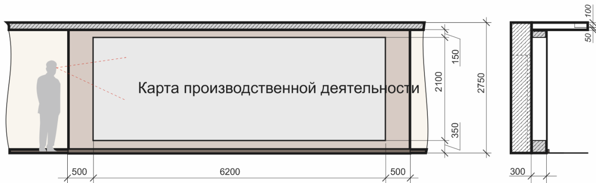
Рис.16. Конструкция объекта "Карта". Привязка к архитектурному проекту помещения
