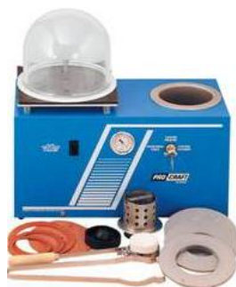
Рисунок 31. Вакуумная литьевая машина с вибростолом PRO-CRAFT 21.800GX
