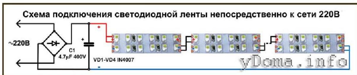
Рис.25. Схема подключения светодиодной ленты к сети
