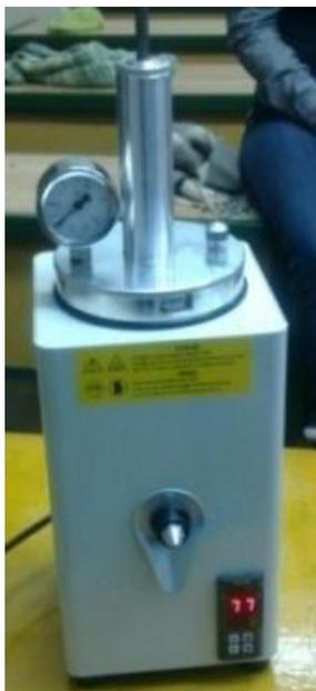
Рис. 22. Инжектор для изготовления восковых моделей.
