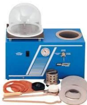
Рис. 23. Литейная вакуумная машина
