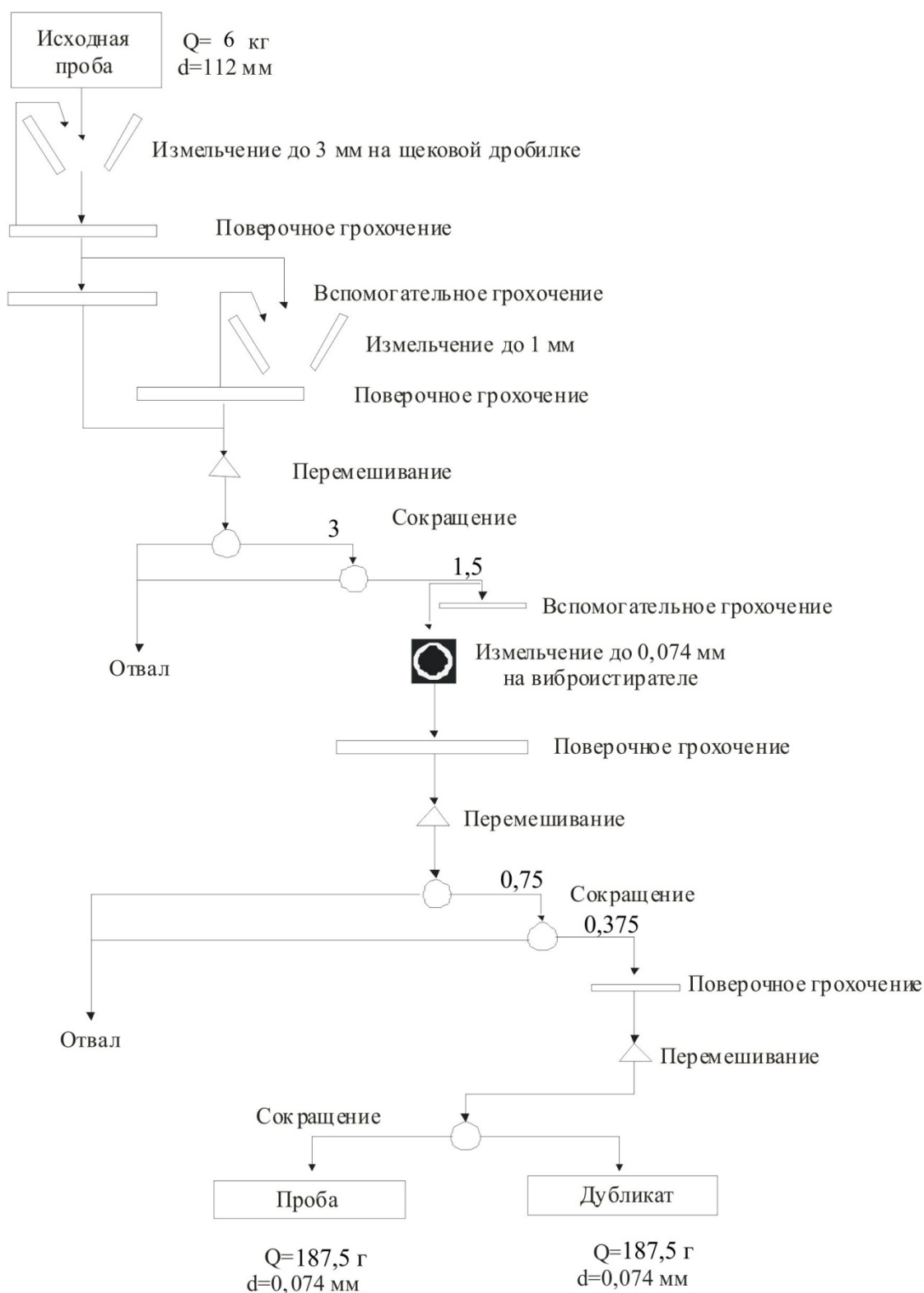
Рисунок 9 – Схема обработки бороздовых проб
