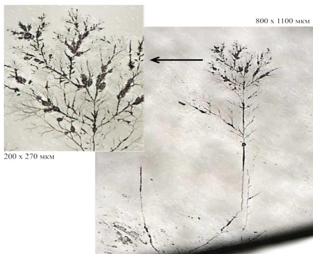
Рис. 2.9. Фотография разрушений, образующихся в эпитаксиальных слоях GaN при облучении СЭП. Навставке—увеличенная фотография «дерева разряда».  $H \sim 0.2 \text{ Дж/см}^2$ .
