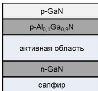
Рис. 2.1 Схематическое изображение структуры исследуемых образцов
