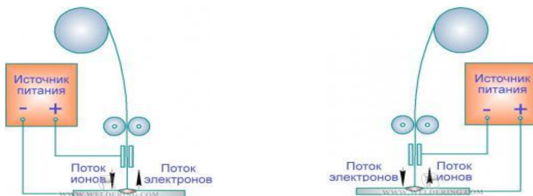
Рисунок 11 – Сравнительный анализ особенностей сварки в защитных газах на обратной и на прямой полярности
