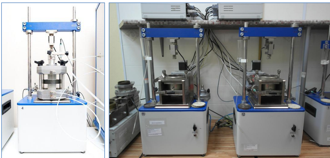
Рисунок 3.6. Приборы АСИС для испытаний грунта на сжатие и срез.
