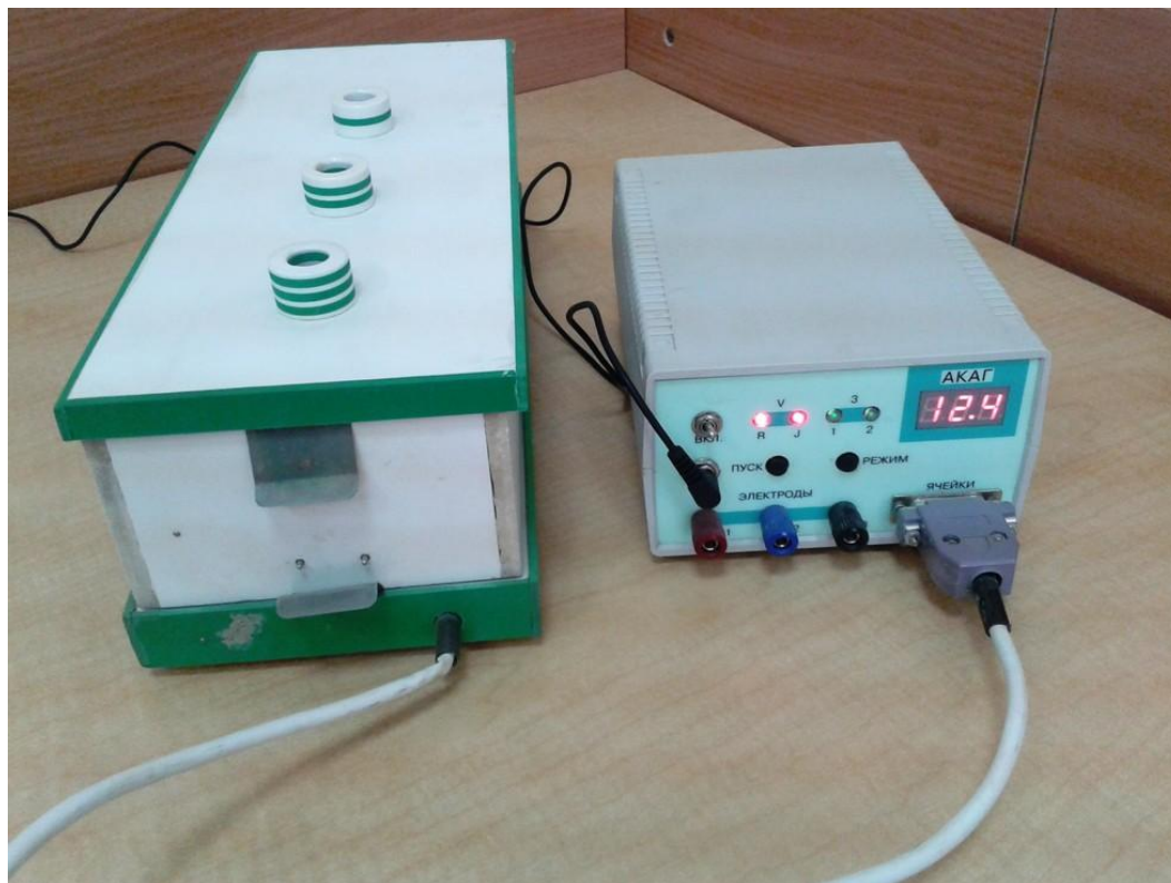
Рисунок 3.7. Приборы АКАГ для определения коррозионной агрессивности грунтов к стали.
