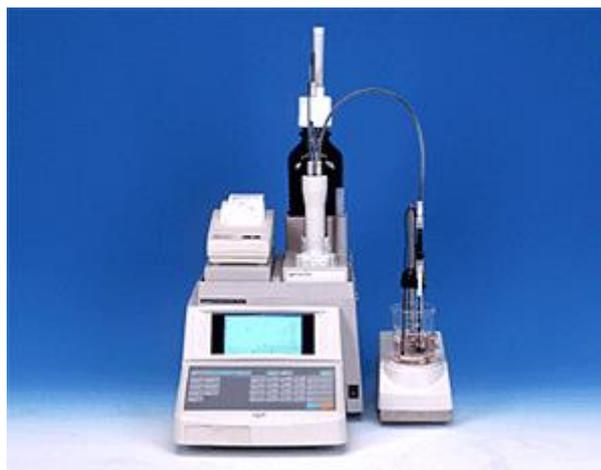
**Рис. 8 Потенциометрический метод определения рН**
