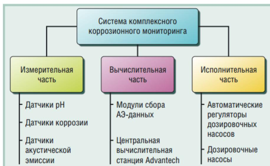
Рис. 6 Структурная схема системы ККМ
