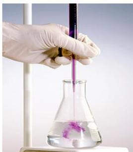
**Рис. 10 Титриметрический метод определения pH**
