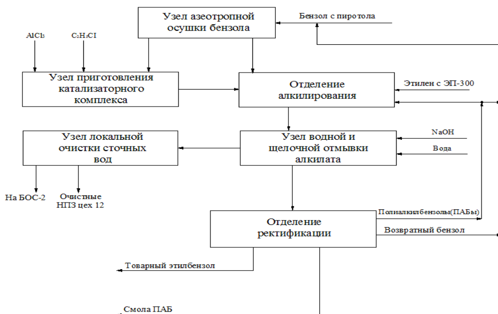
Рисунок 2 – Блок – схемы производства этилбензола
