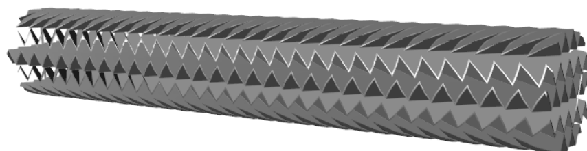
Рисунок 6 – Модель смесительного элемента SMV фирмы Sulzer
