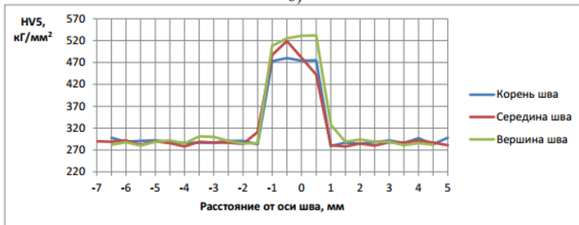
Рисунок 35 – Распределение твердости на поперечных шлифах сварных соединений стали 17ГС, полученных на скорости сварки: а) 10 м/ч, б) 15 м/ч, в) 20 м/ч
