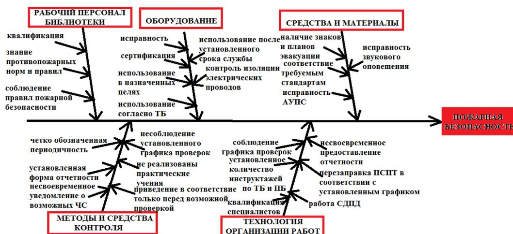
Рисунок 6 – Диаграмма Исикавы для систематического определения причин соблюдения правил пожарной безопасности
