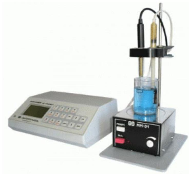
Рисунок 2 – Потенциометр, потенциометрическая ячейка
